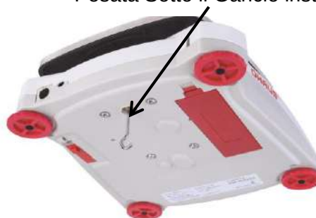
Pesata Sotto il Gancio installato
